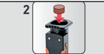
1 Reinigungstablette in die Brüheinheit einsetzen
